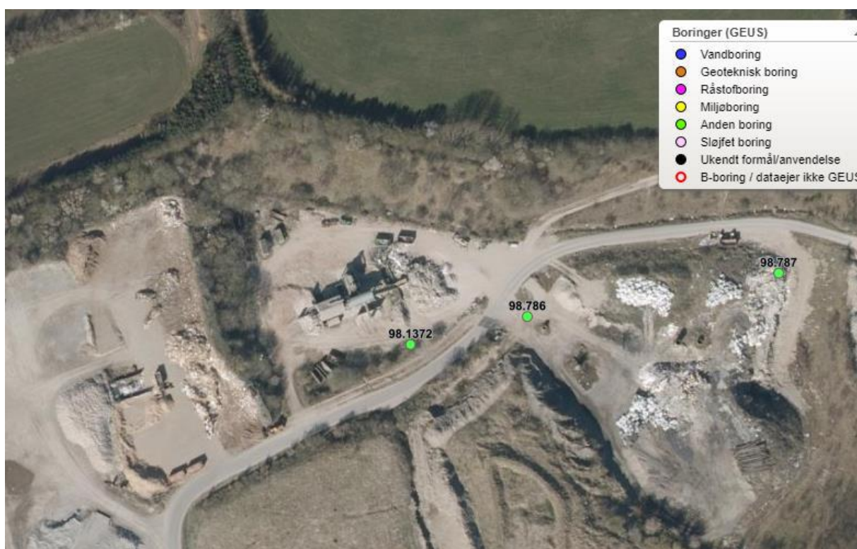
Figur 1 Boringen med DGU nr. 98.1372 skal overbores og der sættes et nyt forerør.
